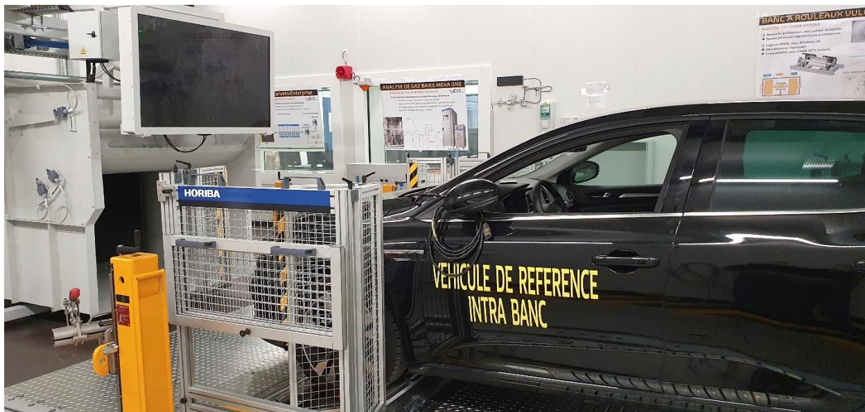
2020 - Inbetriebnahme einer neuen Klima-Konsum-Autonomiebank (-30 / +50C mit Sonnensimulation)
