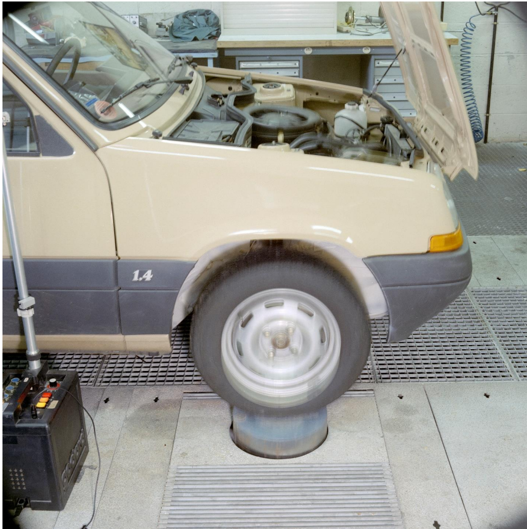
Die ersten Rollenprüfstände wurden 1983 installiert, um Verbrauch- und Abgaswerte vor der Zulassung durchzuführen; seitdem wurden zahlreiche Renovierungen, Änderungen und Ersetzungen vorgenommen.
