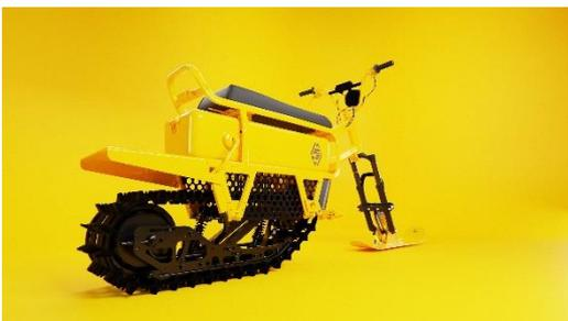
Moonbike ist ein elektrischer Schneescooter, der die Fortbewegung im Winter revolutioniert. Er ist leicht und wendig, hat hinten ein Raupenfahrwerk und vorne einen Ski, erreicht 40 km/h und bietet eine Nutzungsdauer von drei Stunden. Das Antriebssystem ohne Riemen und Ketten erfordert nur minimale Wartung und besticht durch Zuverlässigkeit und Effizienz. Das patentierte Fahrzeug wird in den Alpen gebaut und sorgt für ein unvergessliches Wintererlebnis.
